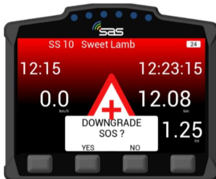
BILD 20: Frage: “SOS-zurücksetzen bzw. herabstufen?” – Antwort noch notwendig
